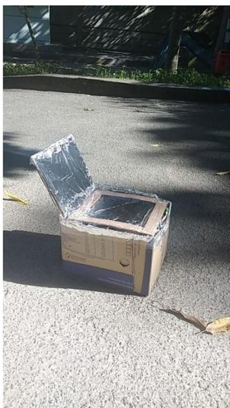
A montagem é simples, primeiramente cortam-se as abas da caixa menor e da maior. Após executar esse passo, cubra a parte interna da caixa com o papel alumínio. Utilizamos durex, pois é mais fácil, mas também é possível usar cola quente ou Super Bonder. A parte interior da caixa menor deverá ser pintada com a tinta preta para podê-la absorver o calor do sol propagado por irradiação.
