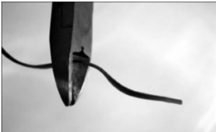
Uma vez que você encontrar uma frequência que lhe dê uma boa recepção, você pode cortar a antena para ficar ainda melhor. O Comprimento da antena deve ser mais longo ou curto dependendo da frequência de acordo com a seguinte fórmula: tamanho em centímetros =  $(300 / \text{frequência}) * 25$  Por exemplo, se você está transmitindo na frequência 100FM, sua antena deve ser  $(300/100) * 25 = 75$  cm de comprimento.
